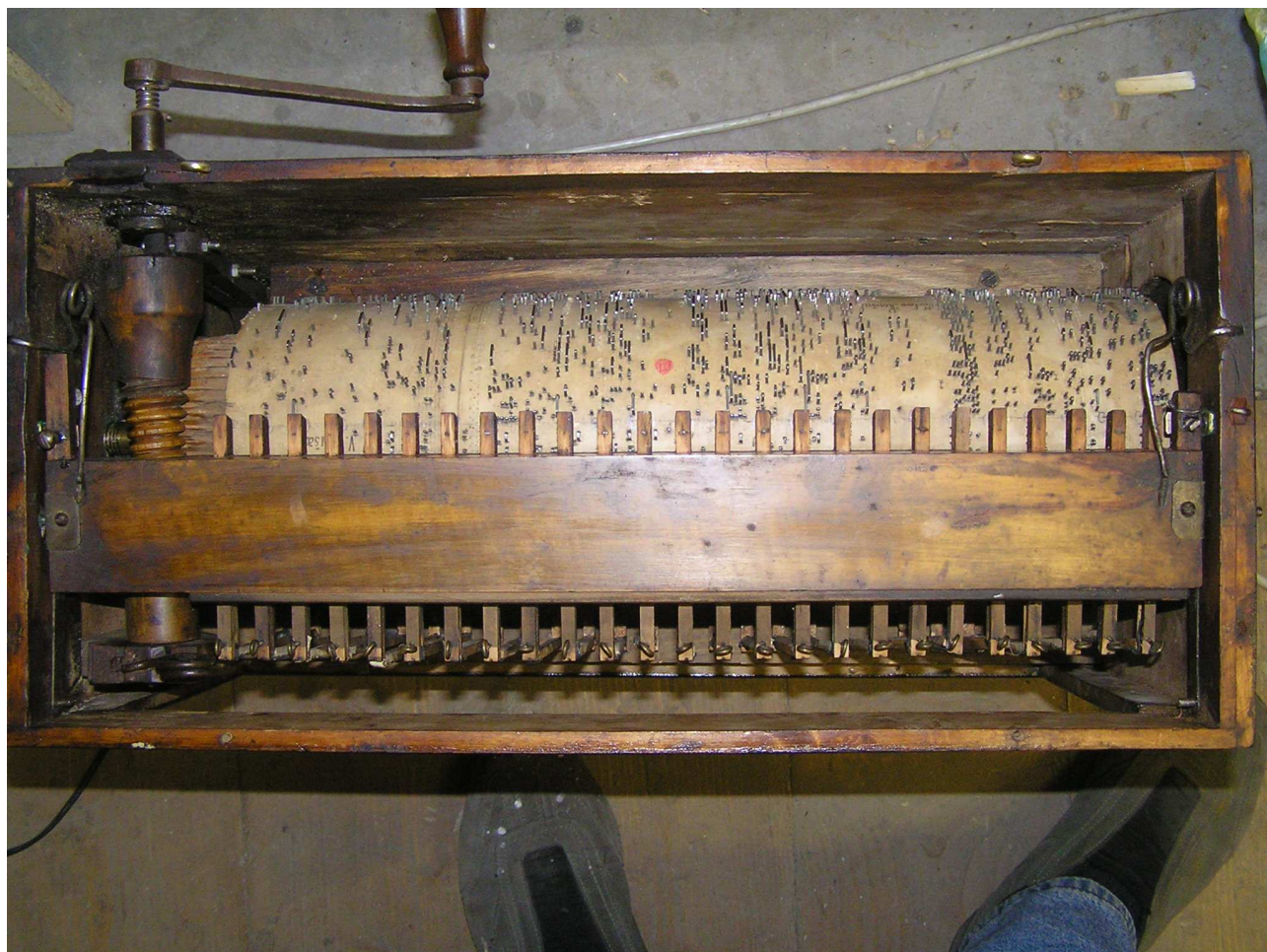
Opravený flašinet, pohled na vnitřní mechanismus
